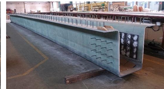
Hibridna mostna konstrukcija (Mostostal, Poljska, 2016)
