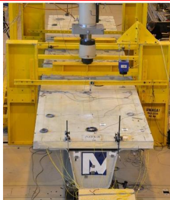
V celoti FRP konstrukcija (Mostostal, Poljska)
