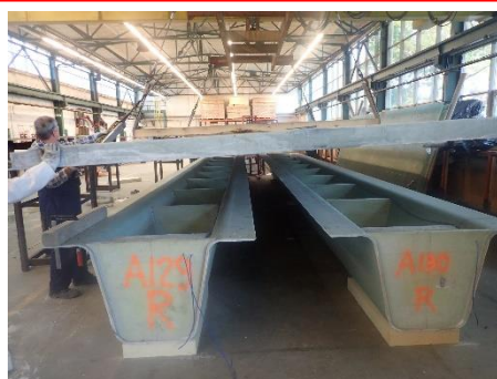
V celoti FRP konstrukcija (Mostostal, Poljska)
