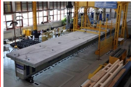
Hibridna mostna konstrukcija (Mostostal, Poljska, 2016)
