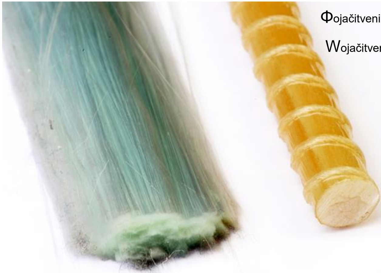
Slika 4: ojačitvena vlakna in stekloplastična armatura.
