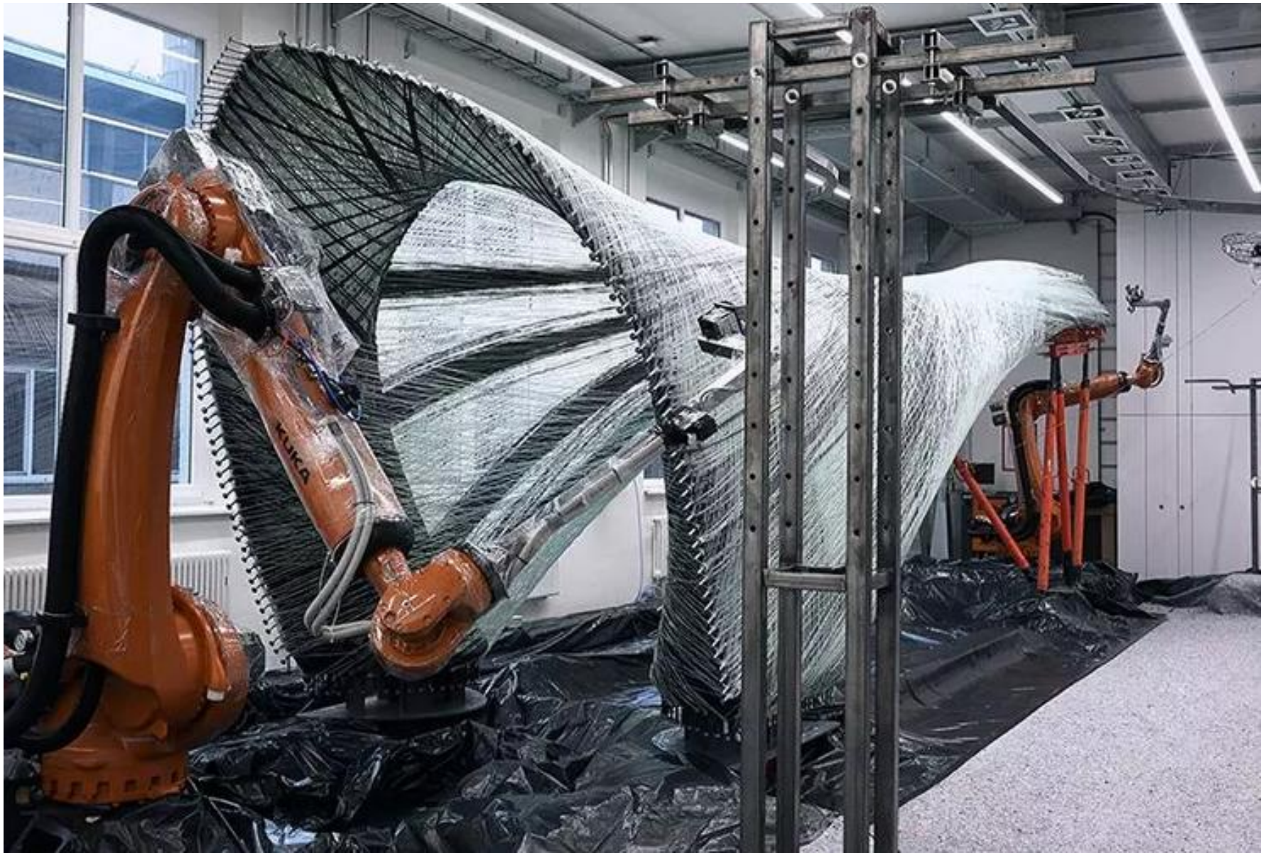
Paviljon iz SIGRAFIL® 50k karbonskih vlaken (vir: https://www.sgllcarbon.com )
